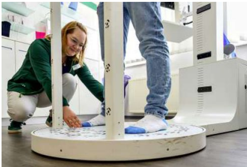
Normalerweise ohne Hose und Socken: Vermessung am „Bodytronic“ zum Anpassen von Kompressionsstrümpfen.
